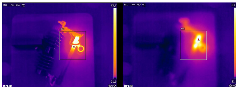
Figur 16.2 Fokuserad infraröd bild (till vänster) med en högsta temperatur på T_{\max} = 89,7 \text{ °C} och en ofokuserad infraröd bild (till höger) med en högsta temperatur på T_{\max} = 73,7 \text{ °C} .
