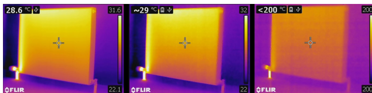
Figur 16.4 Bilder från en FLIR T440 med temperaturområden på -20 till +120 °C, (till vänster), 0 till +650 °C (i mitten) och +250 till +1 200 °C (till höger). Alla andra inställningar är oförändrade.
