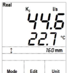
Mätläge för luftflödesmätning i fyrkantig kanal
