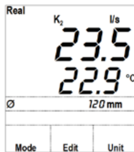
Mätläge för luftflödesmätning i cirkulär kanal
