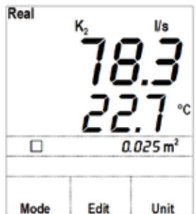
Mätläge för luftflödesmätning med inställd area
