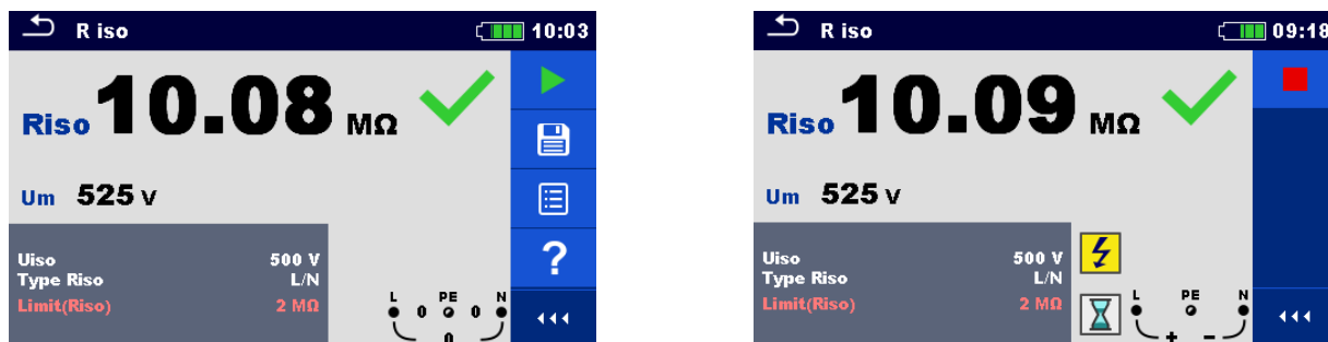
Figur 6.1: Singletest skærm, Eksempel på isolationsmodstandmåling
