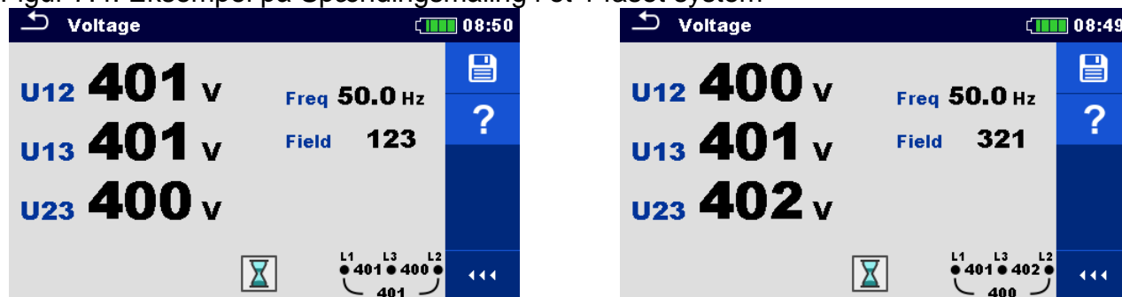
Figur 7.5: Eksempel på Spændingsmåling i et trefaset system
