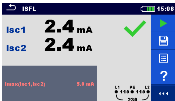
Figur 7.70: Eksempel på resultat af den første fejl lækstrøm måling
