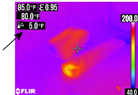
Bild 8-4 Avläsningsexempel på typ-K-/IGM-temperaturdifferential
