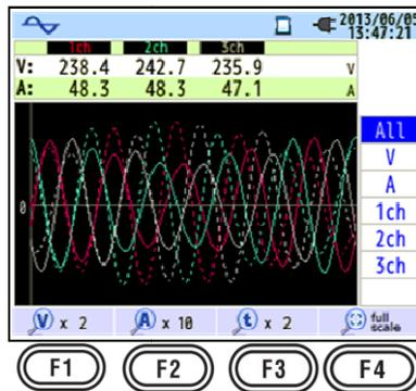
**F1** : toggle the magnifications of voltage waveform (vertical).
