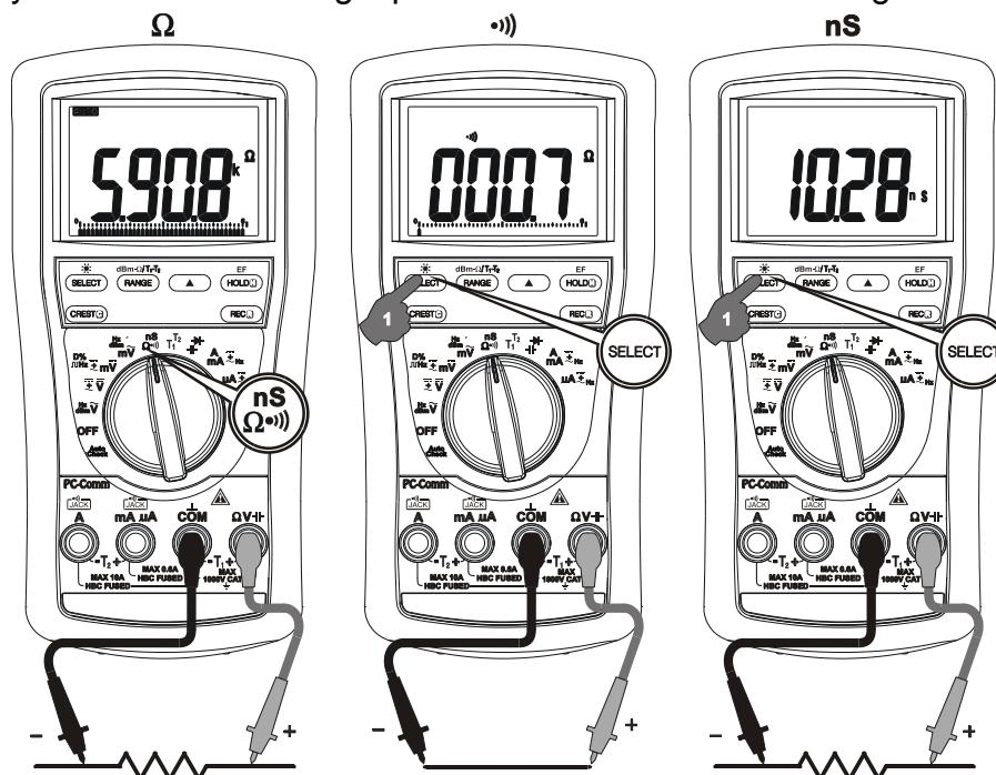
**ADVARSEL!** Ved brugen af gennemgangstest og modstandstest i et spændingsførende system, kan dette give fejlresultater og i værste fald ødelægge instrumentet. I mange tilfælde må den formodet komponent frakobles fra systemet, for at man kan opne en præcis måling.
