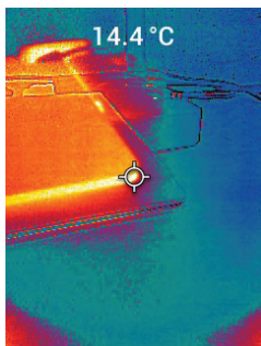
Figur 5.1 Kombinert termografi og fotografi (MSX®)
