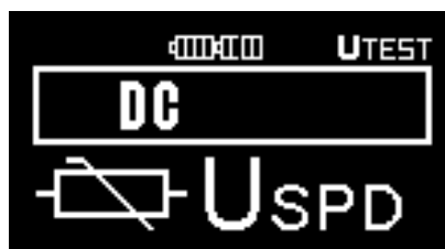
Fig. 3.8 Exempel på inställning av SPD-funktion, DC-funktion är vald
