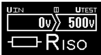
Fig. 3.2a Indikering av lågt batteri
