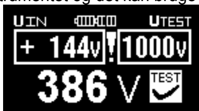
Fig. 3.10a Eksempel på U_{SPD} måleresultat (afladning/utlading er igangværende/pågående)
