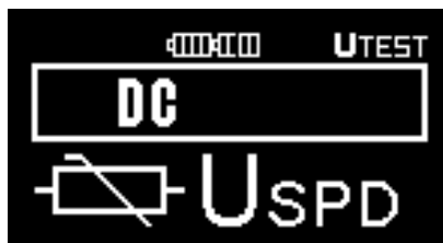
Fig. 3.8 Eksempel på opsætning af SPD funktion, DC funktion er valgt
