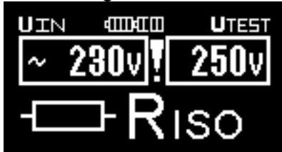
Fig. 3.4a Eksempel af spændingsmåling (RISO funktion)
