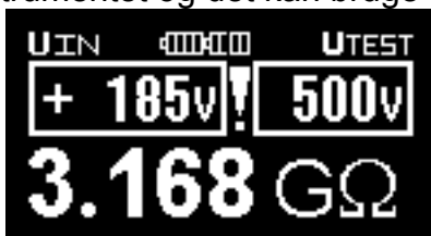
Fig. 3.7a Eksempel af RISO måleresultat (Afladning/Utladning er igangværende)
