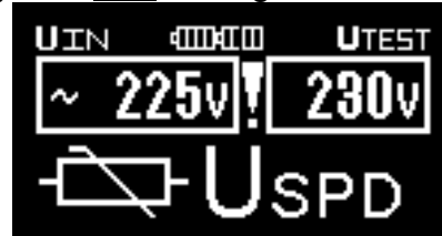
Fig. 3.4b Eksempel af spændingsmåling (USPD funktion)
