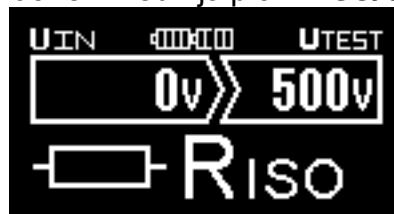
Fig. 3.5 Exempel på inställning för isolationsresistansmätning
