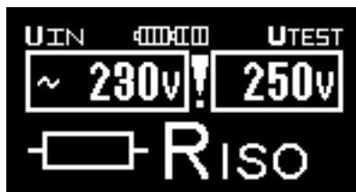
Fig. 3.1 Exempel på spänningsmätning
