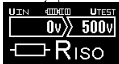
Fig. 3.5 Eksempel af opsætning for isolationsmodstandsmåling
