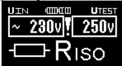
Fig. 3.4a Exempel på spänningsmätning (RISO funktion)
