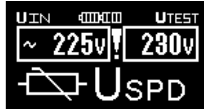
Fig. 3.4b Exempel på spänningsmätning (USPD funktion)
