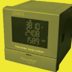
Smart energianalysatorer med mange muligheder. Måler bl.a. sand RMS, spænding, strøm, effekt, cosφ, kvar, kvarh, kVA, frekvens, kW, kWh/fase, +kWh, -kWh, THDF, peakværdier m.m. (strøm indgang for trafo 0-5A) Målingerne vises gruppevis i displayet. Inbygget ur/dato samt RS485 og relæ udgang. (5706445300143)
