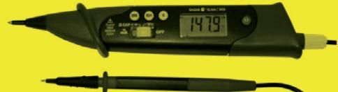
Robust pen multimeter med mange funktioner. Måler spænding 600V AC/DC, strøm 340mA AC/DC, modstand, dioder og gennemgang. Instrumentet er forsynet med HI/LO impedans, relativ- og datahold funktion. Er forsynet med belyst display og lygte som belyser målepunktet. Opfylder KAT III 600V. (5706445840236)
